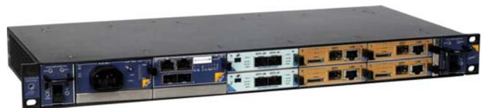
Компактная модульная система ЦОС/ПЛИС TORNADO-mTCA® с двумя сетевыми модулями T/AX-DSFPX и четырьмя AMC-модулями ЦОС/ПЛИС TORNADO-A6678® на базе шести-слотового 19" 1U шасси MicroTCA® с коммутатором 10GbE кросс-панели
