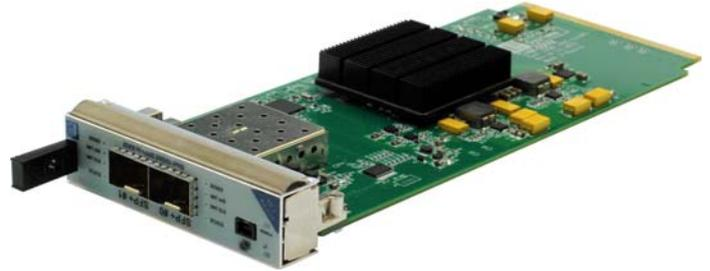
Сетевой AMC-модуль T/AX-DSFPX
