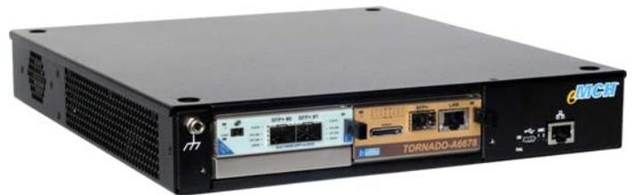
Модульная мини-система ЦОС/ПЛИС TORNADO-mTCA® с сетевым модулем T/AX-DSFPX и AMC-модулем ЦОС/ПЛИС TORNADO-A6678® на базе двух-слотового мини-шасси MicroTCA® с пассивной кросс-панелью
