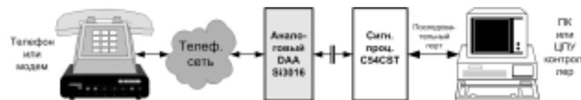
Рисунок 5 Типовая схема использования процессора с Пакетом CST
