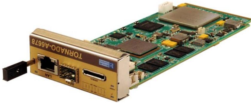
Рис. 3. Супервысокопроизводительный AMC-модуль ЦОС/ПЛИС TORNADO-A6678®.
