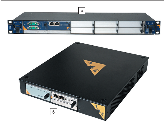
Рис. 5. а) Стандартное 19" 1U шасси MicroTCA; б) мини-шасси MicroTCA
