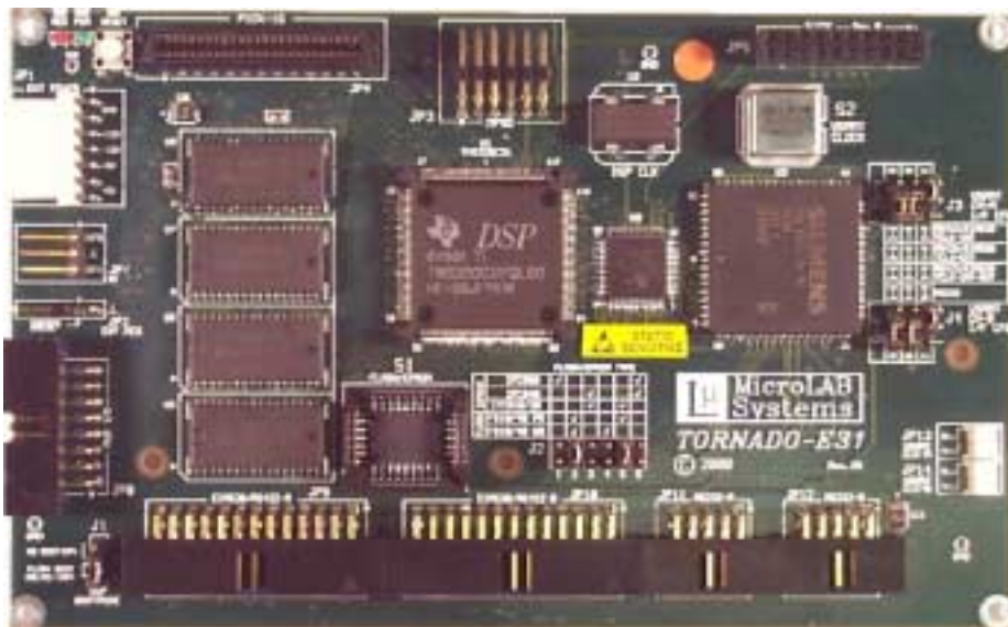
Fig.1-1a. TORNADO-E31 DSP controller board.
